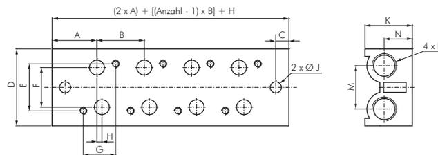
Mehrfachanschlussplatte für 5/2- und 5/3-Wege Ventile
