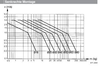
v = Kolbengeschwindigkeit [m/s] m = Dämpfbare Masse [kg]
