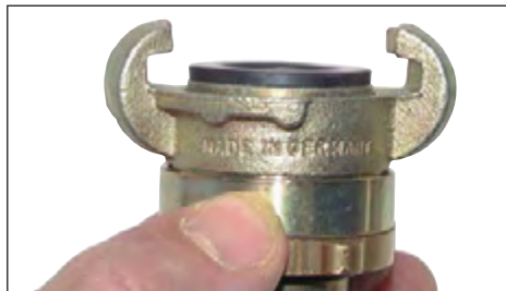
Vorgeschaubte Dichtung - Verbindung ist dicht.
