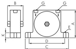
**Werkstoffe:** Gehäuse: Aluminium eloxiert, Kugel und Laufbahn: Stahl gehärtet, Deckel: Edelstahl AISI 303
