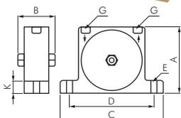
**Werkstoffe:** Gehäuse: Aluminium eloxiert, Rolle und Laufbahn: Stahl gehärtet, Deckel: Edelstahl AISI 303
