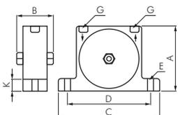
**Werkstoffe:** Gehäuse: Aluminium eloxiert, Turbine: Aluminium, Deckel: Edelstahl AISI 303
