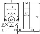
**Werkstoffe:** Gehäuse: Aluminium eloxiert, Kolben: Messing
