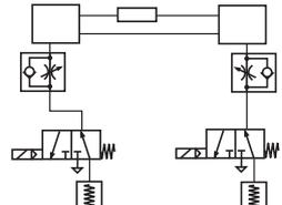
Bei dieser Schaltung können für Vor- und Rückhub separate Eil- und Schleichganggeschwindigkeiten eingestellt werden.
