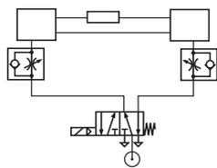
Steuerung zum Anfahren der beiden Endlagen und von Zwischenpositionen mit höheren Toleranzen. Der Zylinder bleibt in einer „Schwimmstellung“, die durch eine Feststelleinheit (Zylindertyp LZB) fixiert werden kann.
