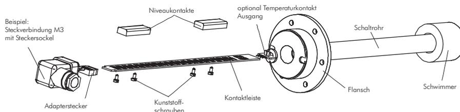
Die Kontakte sind als Schließer (NO) montiert. Da es sich um bistabile Kontakte handelt, ist eine Änderung der Kontaktfunktion beim Schließer- bzw. Öffner Kontakt nachträglich möglich. Diese Änderung wird durch Drehen der Kontakte um 180° erreicht.
