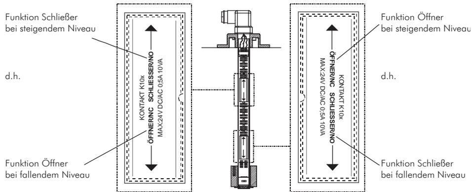
Die Kontaktlogik geht davon aus, dass der Niveauschalter in einen leeren Tank installiert wird d.h. er ist erst nach dem Befüllen in der Betriebsposition.
