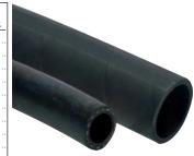
\* Chloropren Außendecke, Temperaturbereich: -30°C bis max. +130°C, Betriebsdruck: 4 bar, Platzdruck: 12 bar, nach DIN 73411/79
