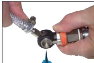
Kupplung ausschwenken - Kupplung schließt und entlüftet
